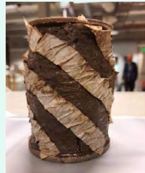
Figuur 1, Triaxiaalmonsters na beproeving. Links monster beproefd zonder membraan; het monster is uit elkaar gevallen. Rechts, monster beproefd met membraan; het membraan is voor de foto verwijderd
