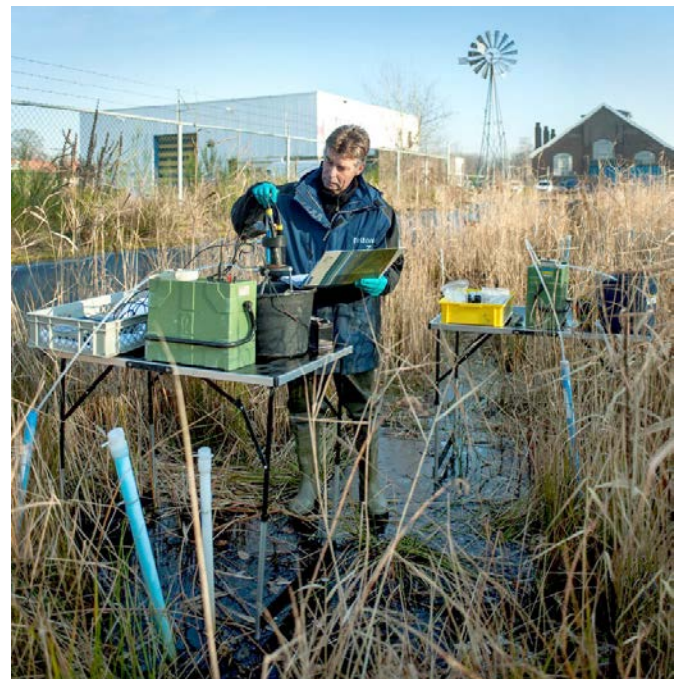
Foto: Monitoring biologische afbraak van chloorkoolwaterstoffen bij dubbelgroene bodemsanering in Amersfoort. (Bron: Deltares)
