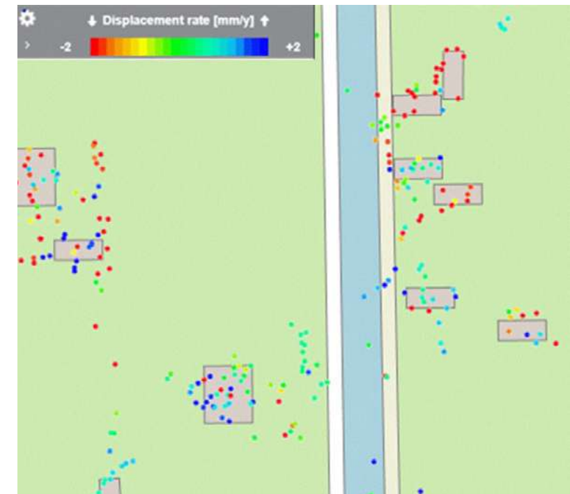
Figuur 5 Voorbeeld van een InSAR kaart met resultaat langjarige zakkingsnelheden in het gebied.
