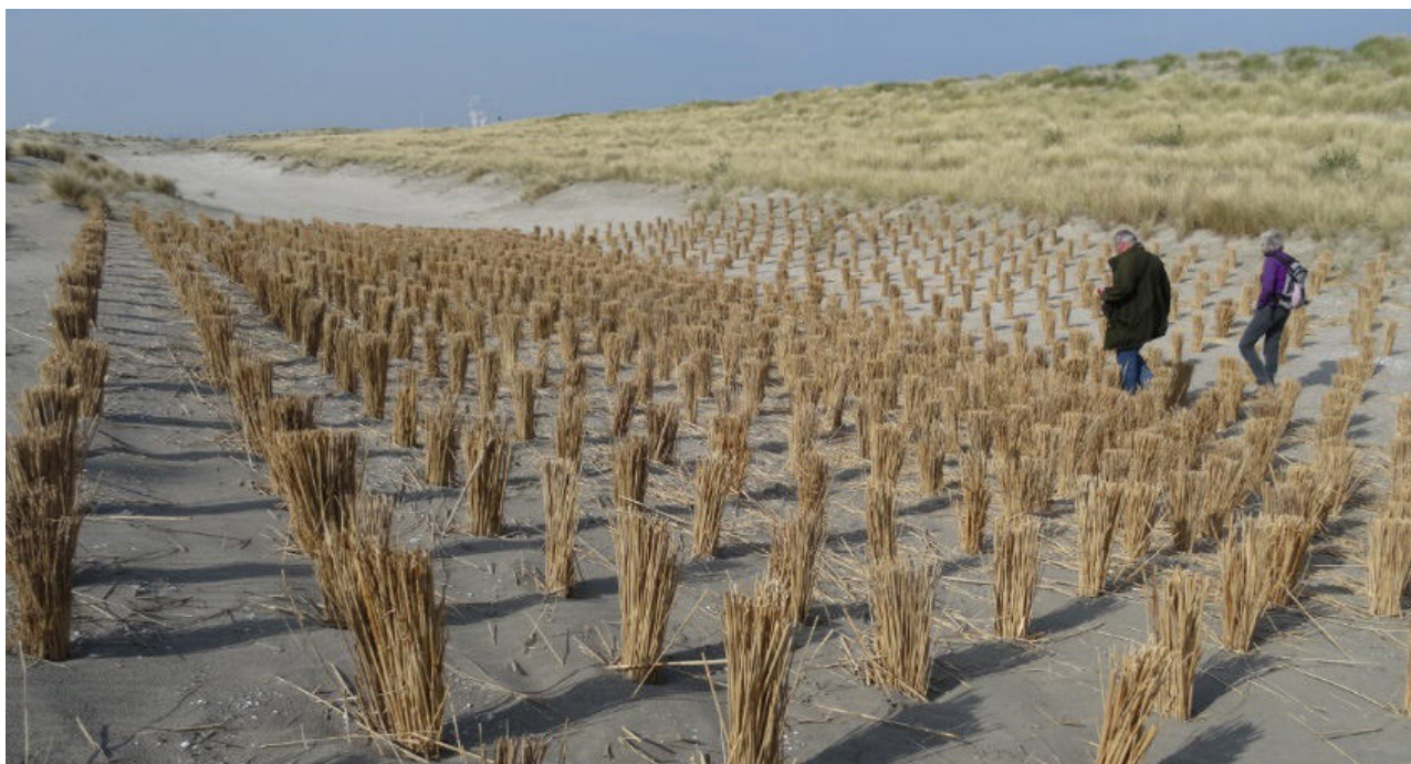
Figuur 30. Beeld van het zgn. rietpootexperiment met één van de vier vakken die zijn aangelegd om het proces van zandinvang te bevorderen en de dynamiek van stuivend zand in de vallei te bestuderen. Foto: maart 2020.
